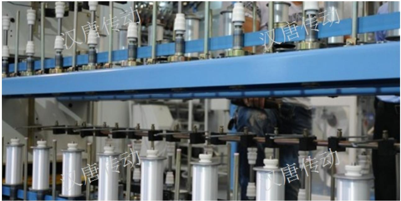
捻机捻度不匀会使股线各片段内纤维抱合力不同，表面纤维的倾斜程度不一致，影响股线的强力、弹性、伸长、光泽和耐磨性等物理机械性能以及外观特征，影响织物的风格与质量。针对倍捻机捻度不匀的问题，快往下看。产生原因龙带张力不匀由于倍捻机是靠龙带摩擦传动锭子对股线进行加捻，因此龙带张力的大小直接影响整台车的锭速。由于龙带本身有一定的弹性，且其张力受气候影响较大。当秋冬季及长时间停车时，龙带收缩大导致张力增大，使锭速增高，春夏则相反。张紧轮进出位置偏差每个张紧轮的进出位置，都会直接影响到相邻两个锭子的锭速，设备技术条件中对张紧轮进出位置有严格要求。实践发现，每个调节单位的偏差都会影响到龙带和锭子的接近度，使锭速偏差增大。汉唐耐磨，耐高温，耐油的XNBR橡胶。辽宁口碑好龙带哪家比较好
